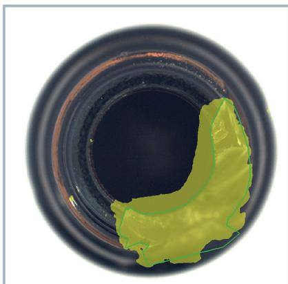
Bild 2. Die Anomalie-Detektion-Technologie in der BV-Software Halcon erkennt selbstlernend einen Fehler am Flaschenhals.
